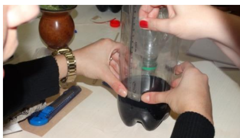
Figura 1: construção do pluviômetro
